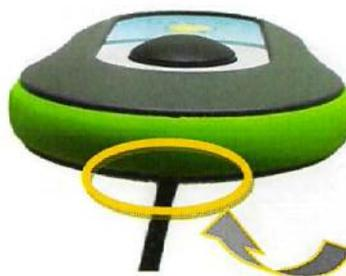
Retirer la vis de verrouillage sous le boîtier. Introduire un petit tournevis plat sous la bague en caoutchouc. Effectuer délicatement un effet de levier avec le tournevis de manière à séparer les deux coques du boîtier de la télécommande.
